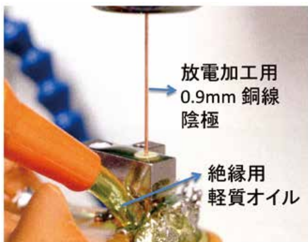
図11 冷却オイル下で型彫り加工中
