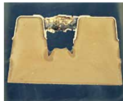
図5 石膏ブリッジ模型を使用し、電鍍ブリッジを完成させ、模型を横断面に分割し、メタルフレームと石膏模型の間隙量をマイクロスコープにて測定した
